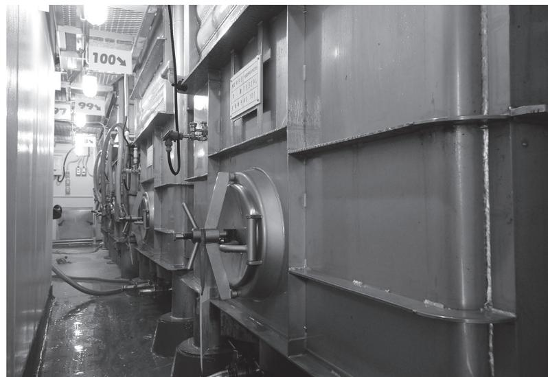
す」なんて、変なことを言う。3トンならジャケット構造で周囲に熱湯を巡らして煮沸できるが、径が大きくなると当然熱は中まで伝わらない。中身を効率よく熱するには対流を起こすために底面から熱しないといけない。しかし、10トンタンクは3トンと同じ側面にジャケットをつけた構造だったから、ちっとも煮沸できなかったのだ。そんなこともあって、ホッピーの品質が落ちていった。その煮沸用10トンタンクは今でも工場にあり、お湯を貯めるタンクとして使われている。
